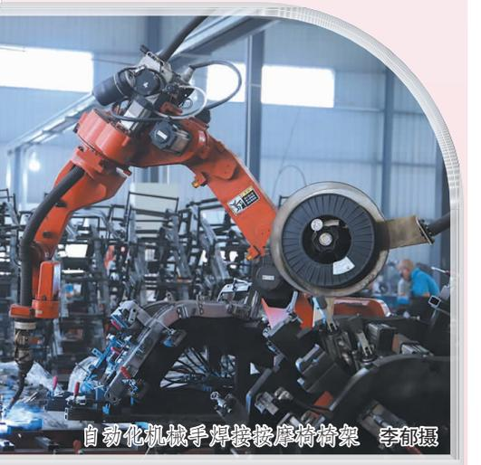
自动化机械手焊接按摩椅椅架 李郁摄
