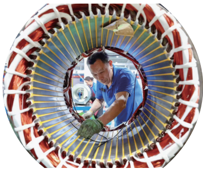
在铨一车间,技工在进行电机主定子漆包线整形工序。 李郁 摄
