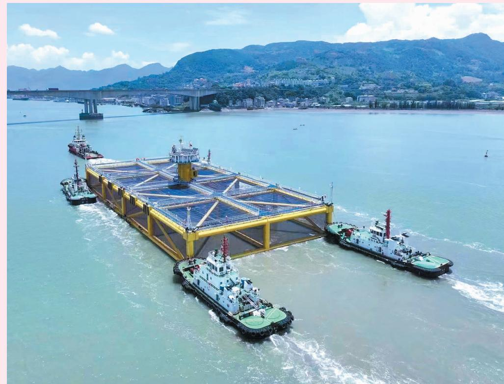
6月27日,我国最大的深远海半潜式养殖平台——宁德1号在福安市东海船厂正式启动拖航,驶向霞浦四礵列岛海域,下一步将进行试验性养殖。据了解,宁德1号项目由福建省南方船业有限公司建造,是全国首座入级中国船级社(CCS)半潜式全框架深海养殖平台。平台总长120米,宽56米,箱体高度12.5米,养殖水体达6.5万立方米,具有可升降、抗台风、避赤潮及智能化养殖等特征,将填补国内深远海自动化养殖大黄鱼的空白。该项目为试验性科研平台项目,主体结构为高强度Z向船板建造,平台装有风力发电、太阳能发电、海洋机器人洗网巡逻等装备,目前已申请6项专利。陈雅芳 摄
