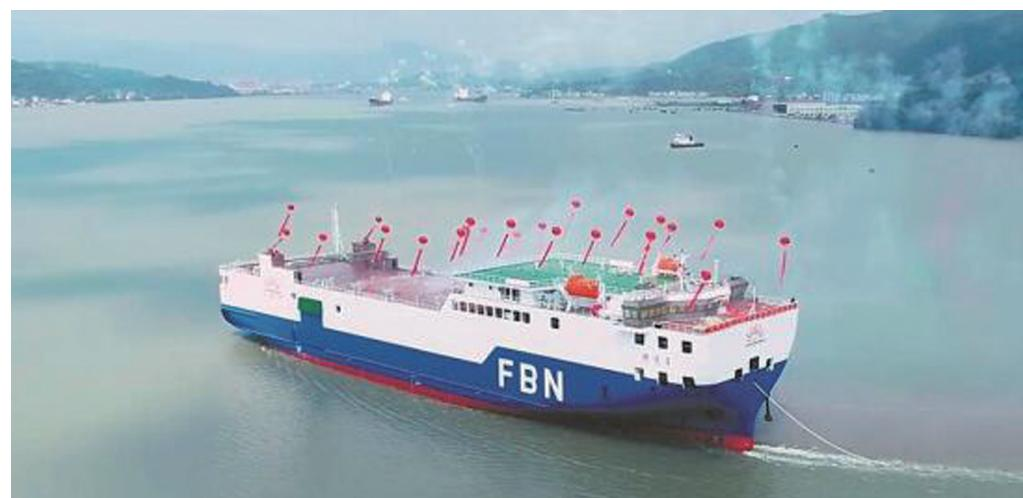
▲近日,由福安市鹏远船业有限公司自主设计建造的滚装船“鹏远3”轮从船厂完成吉水,进入设备调试关键阶段,预计两个月内正式交付印尼客户。“鹏远3”轮总长109米、载重4029.9吨,单次可承载300多辆汽车。作为专门对标国际需求打造的专业滚装船,能够很好适配印尼多岛屿地理环境下的运输场景。
