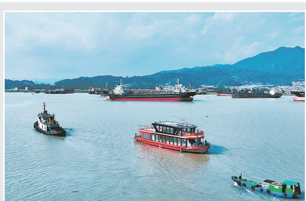
▲8月8日,由我省自主研发、设计和建造的首艘现代双层纯电动游船在我市顺利下水。据了解,该船由福宁重工为福州市内河旅游发展有限公司建造,可满足内河B级航区要求,最高设计航速每小时17.5公里,续航力70公里,零排放,主要用于福州两江四岸游览观光。年初以来,我市制定出台《推动电动船舶发展若干措施》、开展“电动赛江”专项调研,鼓励船舶修造企业持续发力船舶电动化发展。
