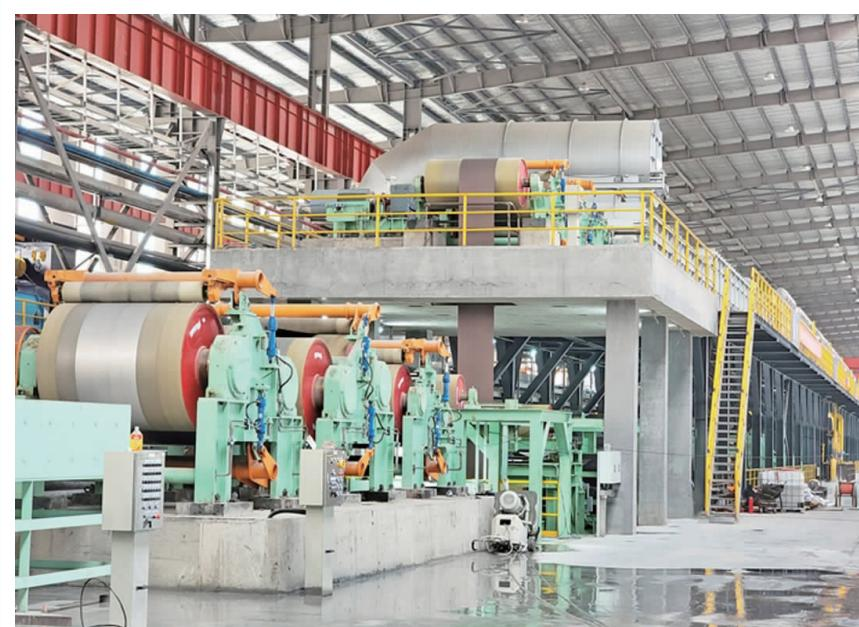
日前,位于湾坞镇的福建宏旺二期扩建项目(一阶段)年产60万吨四机架连轧连退酸洗联合机组首卷钢卷成功轧制下线。据介绍,项目通过采用国际先进的多辊轧机和智能电控技术,推进产线集中控制及“无人化”运行。同时,采用清洁能源和行业领先的环保技术,产线集多种连续式生产工艺于一体,较传统生产线,单位能耗预计降低20%,生产效率预计提升20%。
