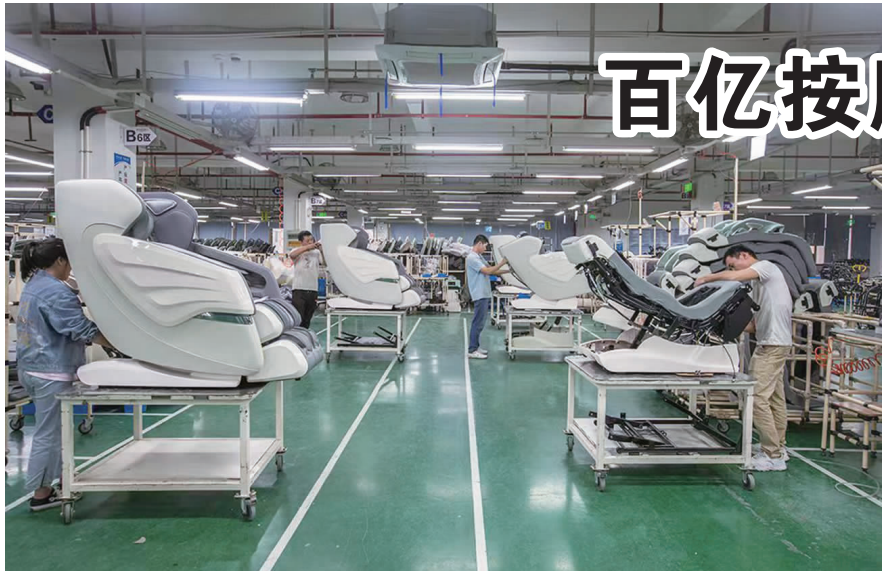
工人正在组装按摩器 李郁 摄
