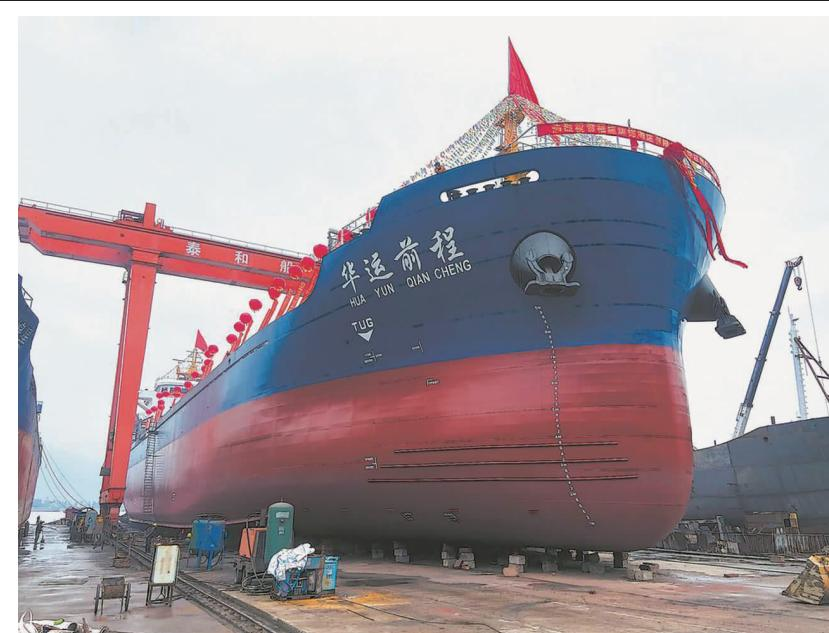
近日,在我市赛江,鞭炮声中,由福建省泰和船业有限公司为平潭籍船东建造的14100吨散货船缓缓滑入江面。据了解,该船于2023年5月开工建设,总长134.9米,型宽22米,型深10米。下一步,该船将进行系泊试验、倾斜试验、航行试验等,预计4月交付使用。
