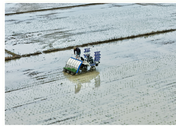
搭载北斗导航系统的高速插秧机在田间灵活穿梭 李郁 摄
