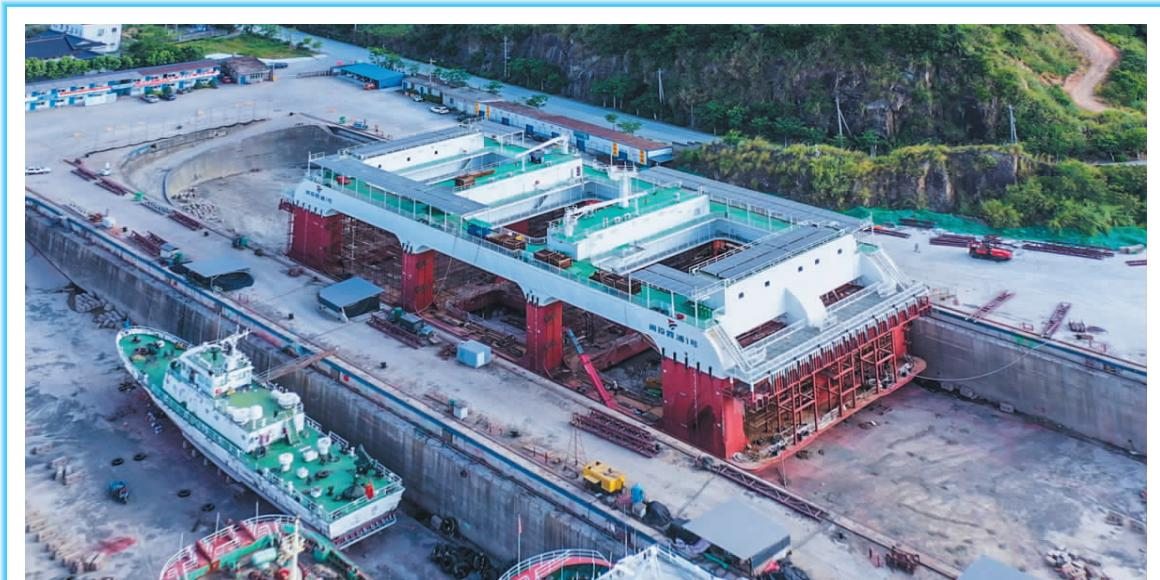
近日,在福安市甘棠镇福宁船舶重工有限公司船坞,数十名工人正加紧对深海半潜养殖平台“闽投霞浦1号”进行网衣架焊接工作,为8月底交付使用开足马力。
