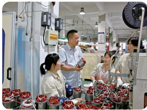
叶宗贤(左二)在给操作人员讲解电机定子绕嵌后,接线绑扎工艺和质量控制注意事项。 吴其文 摄
