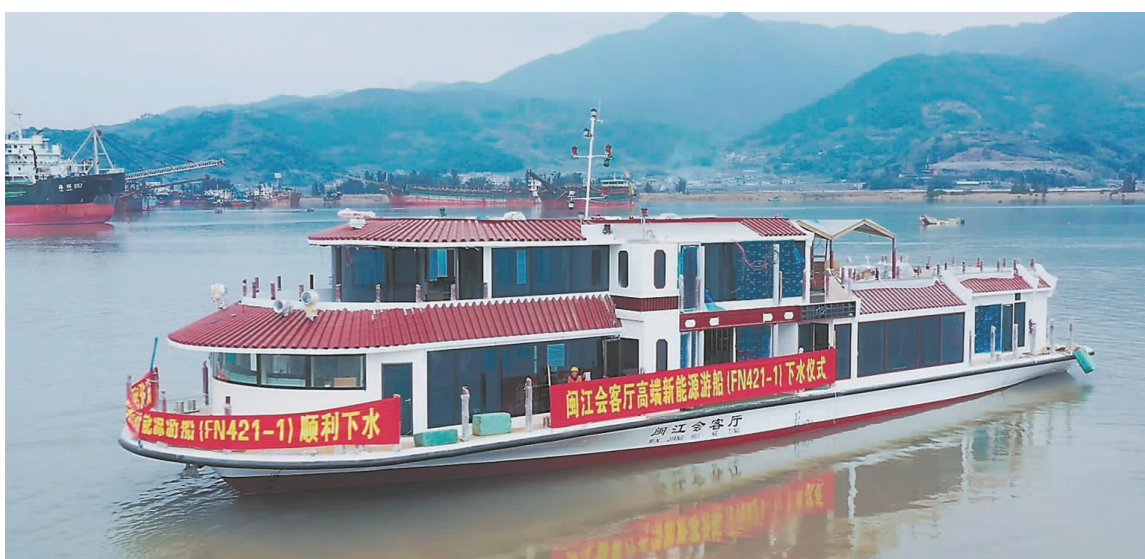
16日,由福宁船舶重工有限公司建造的高端新能源游船“闽江会客厅”在我市顺利下水。据悉,该游船是首艘福建建造高端新能源游船。“闽江会客厅”设计总长40.9米、总宽10.8米,可载212人,配备有宁德时代锂电池、150千瓦单台电机,最高时速可达10节。记者在现场看到,该游船采用福
