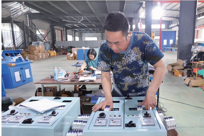
福建航电生产车间内,员工在装配“三电”系统中的电控部分
