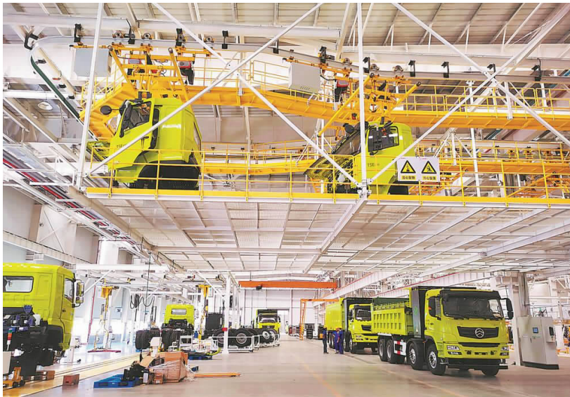
青拓重工矿卡车间的空中自行车驾驶室转运线
